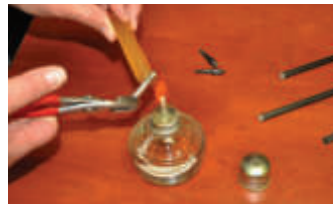
Erhitzen Sie den Kleber ebenfalls über der Flamme, bis die Oberfläche glänzt
